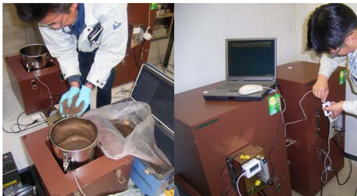
<小型堆肥化実験装置「かぐやひめ」> 左: 竹を割ったような筒への仕込み 右: 発酵状況サンプリング
