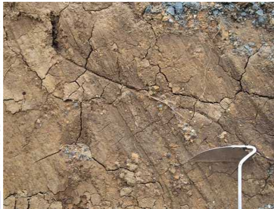
写真11：写真10の断層面の拡大写真。この断層面の条線は65~82度で南落ちを示す。
