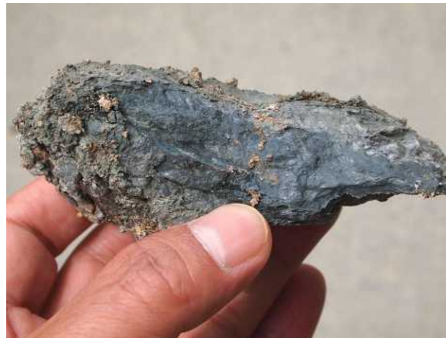
写真3：地震断層に伴う断層ガウジの近接写真。鏡肌を呈し、スリッケンステップが確認できる。
